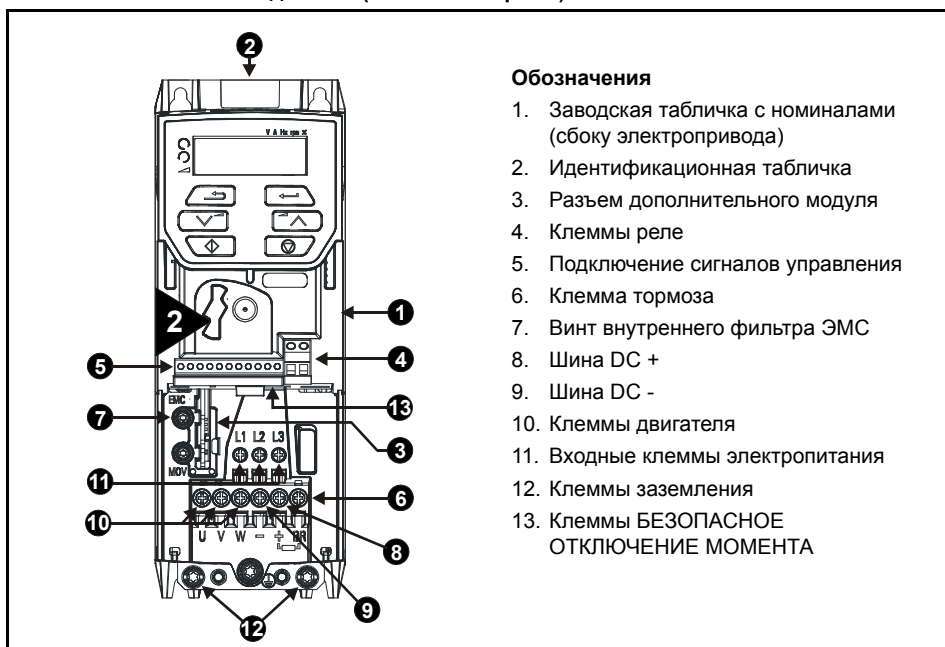
Рис. 3-1 Расположение деталей (показан габарит 2)
